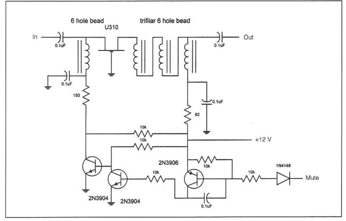
Fig 12.74—The LNA/attenuator.
